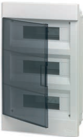
V52436 36 modula, zajedno s vodilicom DIN (60715 TH35), bijela RAL 9003, s prozirnim zatamnjanim vratašcima. Izgubljena snaga: 68 W
