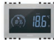
02955.BN Ekran na dodir, upravljanje funkcijama ON/OFF i PID temperature, 1 ulaz senzora temperature, 1 višefunkcijski ulaz, 1 ulaz RJ9 za mjerač energije (02960) preklopni relejni izlaz 5(2) A 230 V~ - 3 modula. Dubina: 35,3 mm
