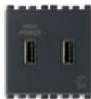
19295 5 V 2,1 A napajač s izlazom, 2 izlaza USB koji sveukupno daju 2,1 A, 120-230 V~ 50/60 Hz - 2 modula. Dubina: 37 mm
