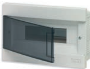
V52412 12 modula, zajedno s vodilicom DIN (60715 TH35), bijela RAL 9003, s prozirnim zatamnjanim vratašcima. Izgubljena snaga: 28 W
