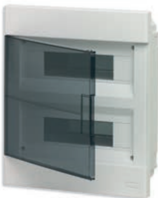
V52424 24 modula, zajedno s vodilicom DIN (60715 TH35), bijela RAL 9003, s prozirnim zatamnjanim vratašcima. Izgubljena snaga: 58 W
