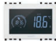
02955.B Ekran na dodir, upravljanje funkcijama ON/OFF i PID temperature, 1 ulaz senzora temperature, 1 višefunkcijski ulaz, 1 ulaz RJ9 za mjerač energije (02960) preklopni relejni izlaz 5(2) A 230 V~ - 3 modula. Dubina: 35,3 mm
