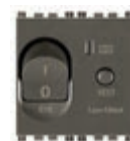
▲19411.10.M C 10, I_{\Delta n} 10 mA, prekidna moć 3000 A - 2 modula. Dubina: 39 mm
