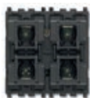
▲01482 4 gumba + aktivator 1 rolete s usmjeravanjem lamela , relejni izlaz za motor cosφ 0,6 2 A 120-240 V~ 50/60 Hz - 2 modula Dubina: 37 mm
