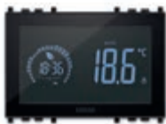
02955 Ekran na dodir, upravljanje funkcijama ON/OFF i PID temperature, 1 ulaz senzora temperature, 1 višefunkcijski ulaz, 1 ulaz RJ9 za mjerač energije (02960) preklopni relejni izlaz 5(2) A 230 V~ - 3 modula. Dubina: 35,3 mm
