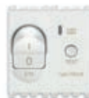
19411.10.B C 10, I_{\Delta n} 10 mA, prekidna moć 3000 A - 2 modula. Dubina: 39 mm
