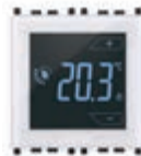
02950.B Ekran na dodir, upravljanje funkcijama ON/OFF i PID temperature, 1 ulaz senzora temperature, 1 višefunkcijski ulaz, preklopni relejni izlaz 5(2) A 230 V~ - 2 modula. Dubina: 38,5 mm
