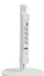
Samostojec in premični drog, enostranski. Vnaprej ožičen, opremljen s 4 vtičnicami z ozemljitvijo ob strani, USB tip A in USB tip C vtičica s kablom in 2x Kat. 6A S/FTP (Actassi) s kablom. Vključuje končni element in navodila za montažo. Ozemljen. Noga je vključena. Zunanji kabli: en neoklepjen 3 x 1,5 mm<sup>2</sup> kabel z vtičem z ozemljitvijo ob strani, 6,0 m skupna dolžina, in dva Kat. 6A S/FTP (Actassi) podatkovna kabla z RJ45 vtiči, 10,0 m skupna dolžina.
